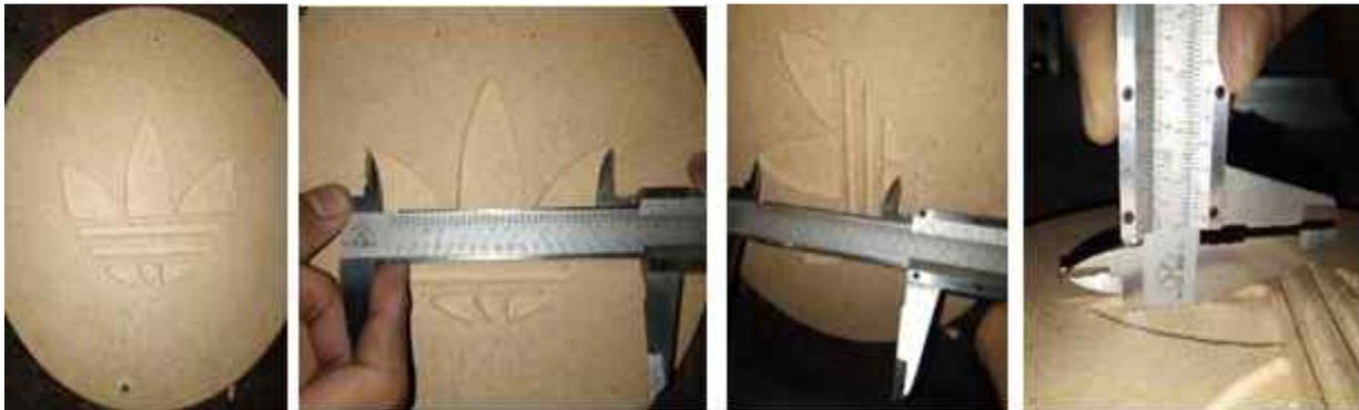
Gambar 5. Hasil Pengujian Benda Kerja hasil program Aspire
