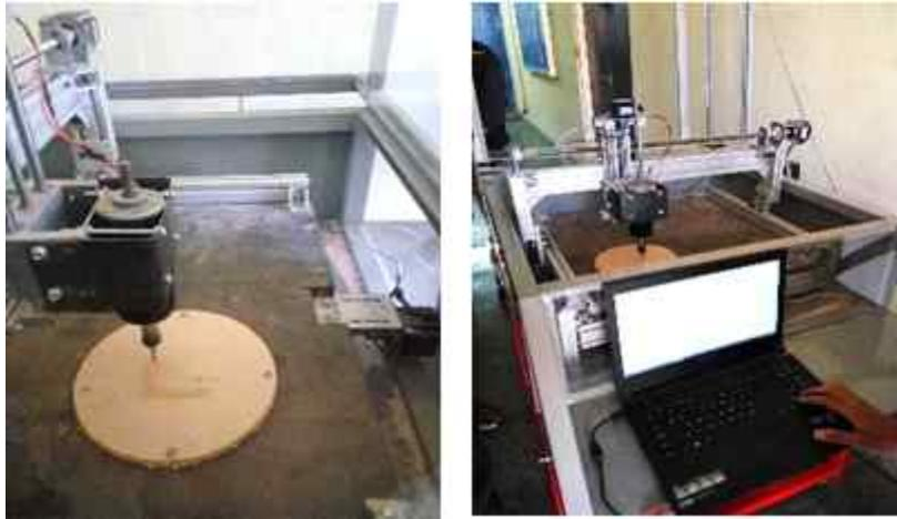
Gambar 2. Mesin CNC Router Mini
